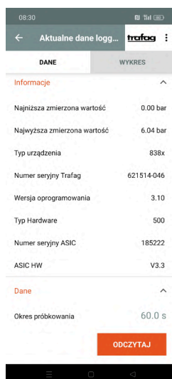
Przykładowe dane zebrane po 24 h pracy przetwornika DPS z wykorzystaniem zasilania bateryjnego. Czas próbkowania: co 60 s.
