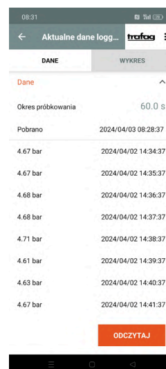
Przykładowe dane zebrane po 24 h pracy przetwornika DPS z wykorzystaniem zasilania bateryjnego. Czas próbkowania: co 60 s.
