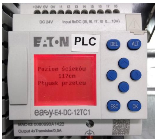
Rys.3.4.1. Ekran zdarzenia: Pływak przelew
