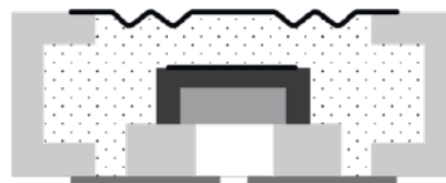
Ilustracja przedstawia piezorezystancyjny czujnik ciśnienia z membraną rozdzielającą, wypełnieniem olejowym i warstwą aktywną.
