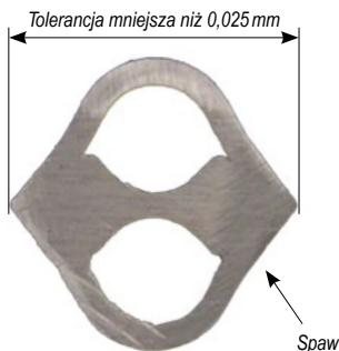
Profil czujnika DF25: Spawy w niekrytycznych zaokrągleniach, brak zmian wymiarów na powierzchniach czolowych.
