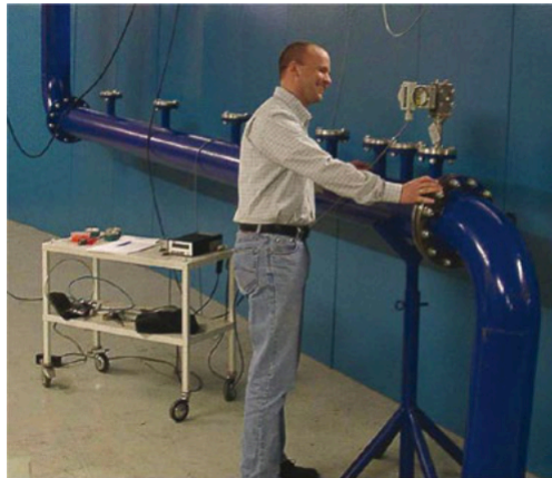
Na stanowisku kontrolnym mierzony jest wpływ skróconych obszarów wlotowych na deltaflow.
