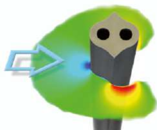
Rysunek 13. Prędkość przepływu na krawędzi Deltaflow jest przyspieszana ok. 2,3 raza
